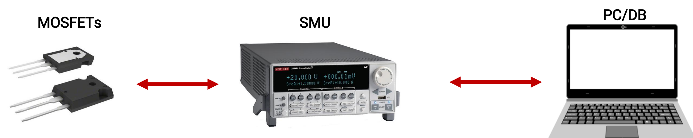
Figure 2 – Configuration d'un banc de test pour l'acquisition de la caractéristique I_D = f(V_{GS})
